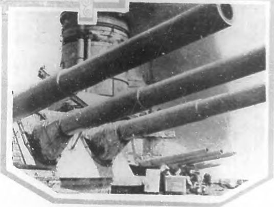
El "DUQUISSE", crucero tipo "Washington", construido en 1925. Desplaza 10.000 toneladas. Velocidad máxima 35 1/2 nudos. Armamento: 8 cañones de 8". Forma con el "Trenton", el "Swanton" y el "Cahoon" la mejor división de la escuadra francesa. (FOTO LAFIN)
